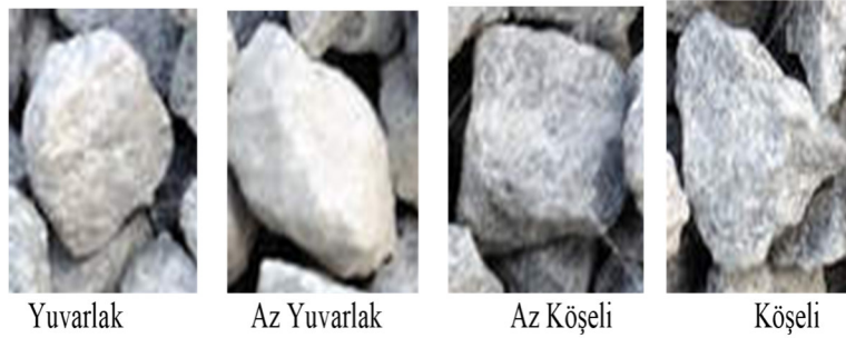
Şekil 4. Agregada dane şekilleri.
