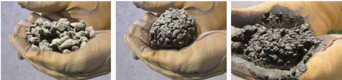
Şekil 3. Geçirimli betonun su miktarının işlenebilirliğe etkisi[13]
